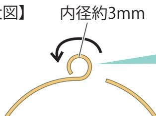
最初に丸く曲げる際、コイルの太さ分だけ外側にずらして曲げるときれいに仕上がります。
